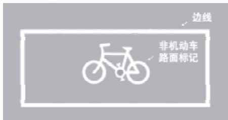
图 3 非机动车停车设施标线
