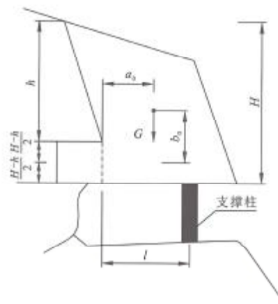
图 M 1 后缘有陡倾裂隙坠落式崩塌支撑体反力计算示意图
